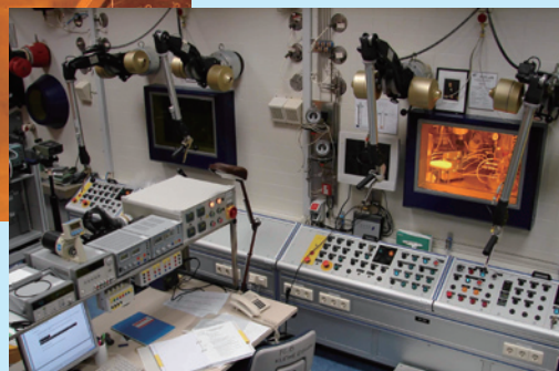
ドイツ・超ウラン元素研究所に設置したアルゴン雰囲気ホットセル
