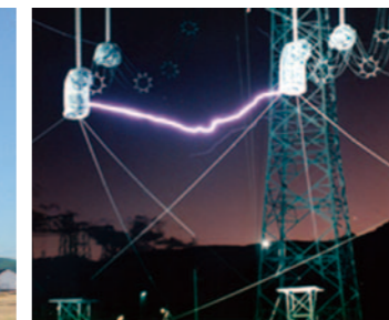
送電線の雷実験
