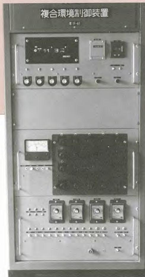
図 2-1-9 複合環境制御装置
