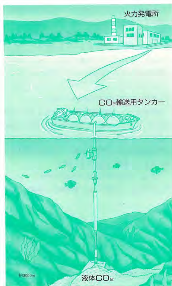
図2-2-5 深海底にCO 2 を貯留した場合のイメージ図
