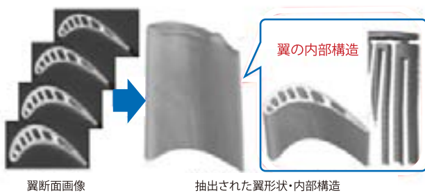
図 3-4 X線CTによるGT翼の非破壊計測
