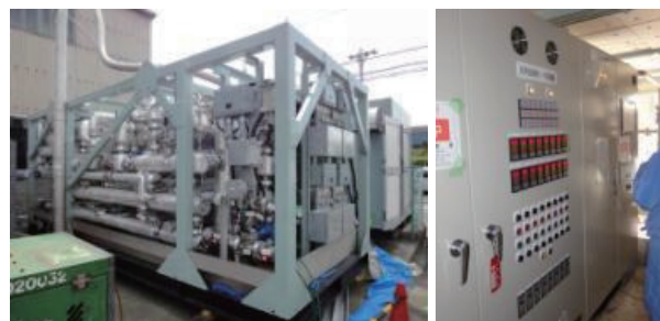
図3-2 移動式加熱強制循環洗浄装置 左写真はAユニットの外観、右写真はBユニットの操作盤
