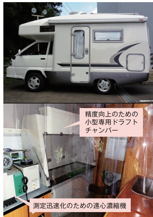
図2-3 分析車の外観と車内の分析設備 (写真：株式会社セレス提供)
