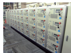
PVパネル模擬電源 (11kW×36台) ▶PVパネルのI-V特性を模擬
