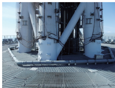
左:東京スカイツリーへの落雷の電流波形を計測する装置(ログスキーコイル)、 右:東京スカイツリーでの雷撃電流波高値の累積頻度分布
