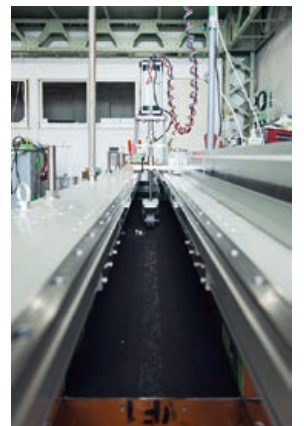
屋内小型模型実験装置における 道路上を走行する模擬タイヤ
