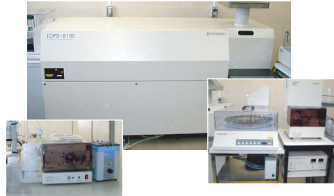
水素化物発生装置（左）、ICP誘導結合プラズマ発光分析装置本体（中）、オートサンプラ・超音波ネブライザ（右）
