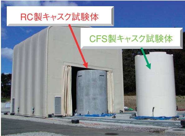
図1 実物大コンクリートキャスク試験体 試験に用いた二種類のキャスク。なお、使用済燃料から発生する崩壊熱は電気ヒータで模擬した。
