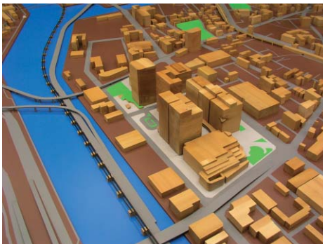
図2 実市街地を対象にした風洞実験の様子
