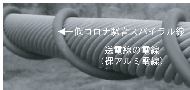
図2 開発した低コロナ騒音スパイラル線 (チタン基材)
