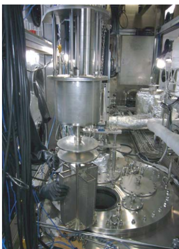
(電解精製装置)
