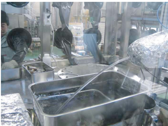
図3 重力での溶融塩の流出挙動
