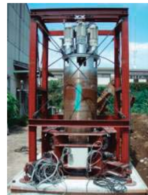
図2 当所が開発した「原位置岩盤三軸試験システム」
