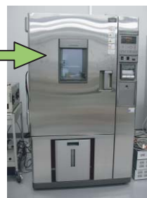
図5 ステンレス鋼がSCCで破損する時間を調べるための試験
