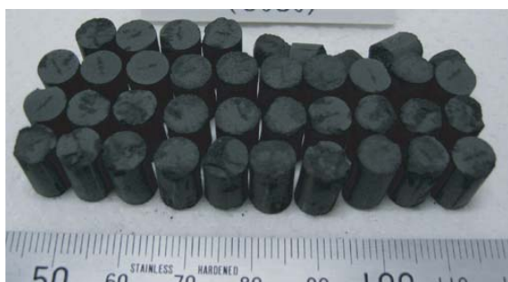
図2 前処理により作製した多孔質性の酸化物ペレット：代表的FP元素のCe,Nd,Sm,Sr,Zr,Mo,Pdを各1wt%含有したUO 2 で、気孔率は32%。
