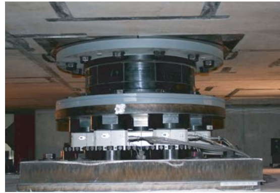
図1 水平免震構造試験体と鉛プラグ入り積層ゴム（実機の約1/3）の設置状況
