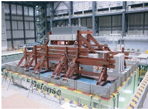
図1 水平免震構造試験体と鉛プラグ入り積層ゴム（実機の約1/3）の設置状況
