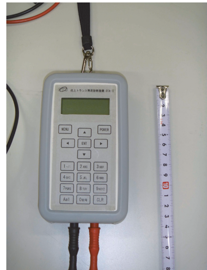
図2 柱上変圧器の携帯型巻線短絡判定器 この装置の測定線を柱上変圧器の巻線につなぐだけで巻線短絡の有無を即座に判定できる。 (試作：(株)電力テクノシステムズ)
