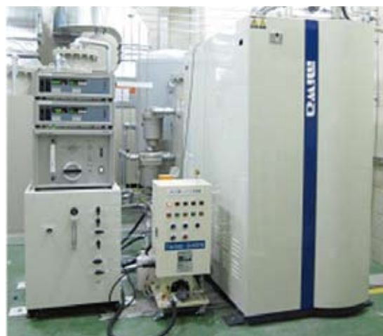
写真2 低濃度CO 2 発生装置の外観
