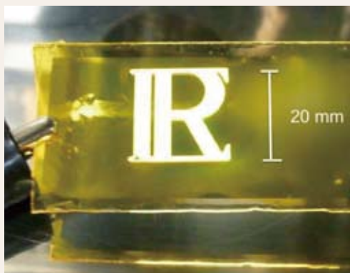
図2 イオン液体と有機発光ポリマーで構成した有機発光デバイスの試作
