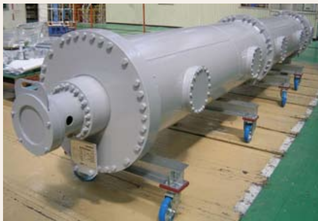
図5 試作した300kV級ハイブリッドガス絶縁母線モデルを設置するタンク外観
