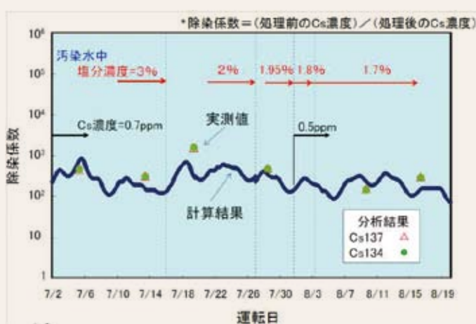
図1 福島第一原子力発電所滞留水処理システムを模擬した小型試験装置(左)と開発したコードによる実機の解析結果(右)
