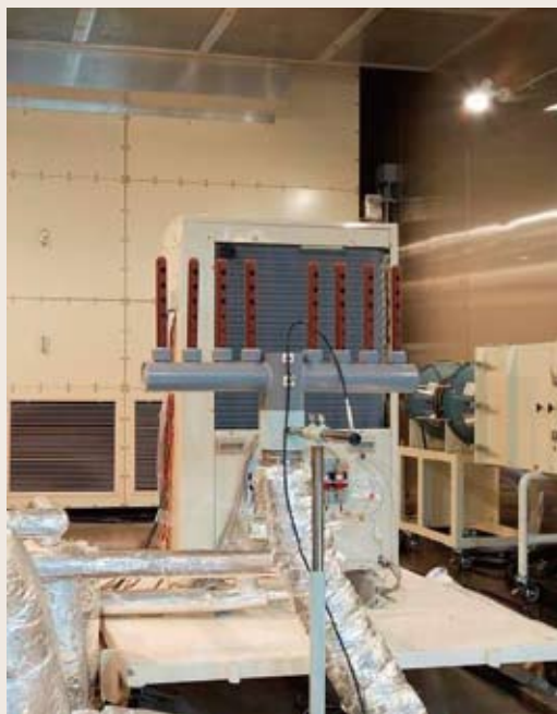
図2 当所のヒートポンプ性能評価試験設備に設置した寒冷地向けCO 2 ヒートポンプ式温水暖房機
