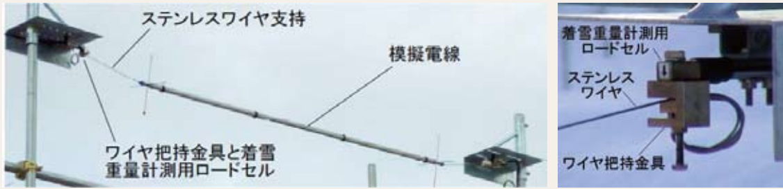
図1 電線着雪簡易観測装置「ワイヤ支持式着雪サンブラ」
