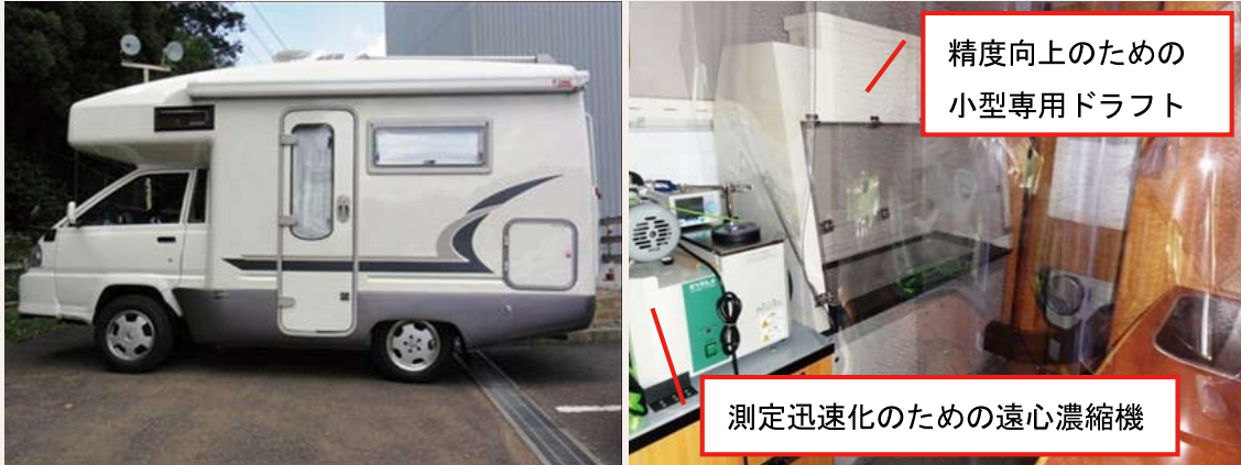
図1 PCB分析車の外観と車内の分析設備
