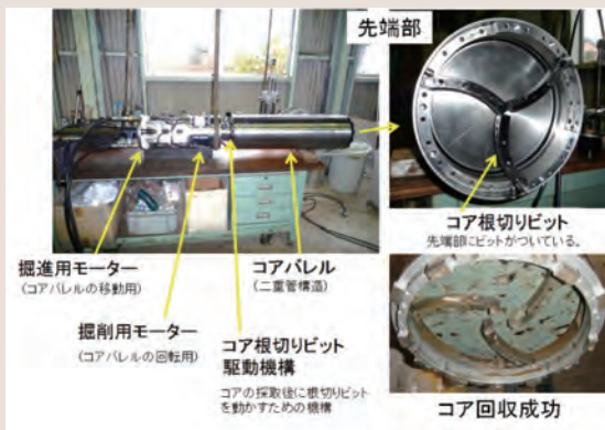
図3 開発した大型ボーリングコア採取装置 高品質の断層をサンプリングするため、直径20cmの大型のボーリングコア採取装置を考案(特許2件出願)・試作した。試作した装置を用いて、凝灰岩のサンプリングを行い、下端の切断・回収やゴムスリーブの挿入が正常に機能することを確認した。
