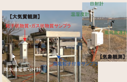
(a) 腐食環境測定装置 (2013年3月設置)
