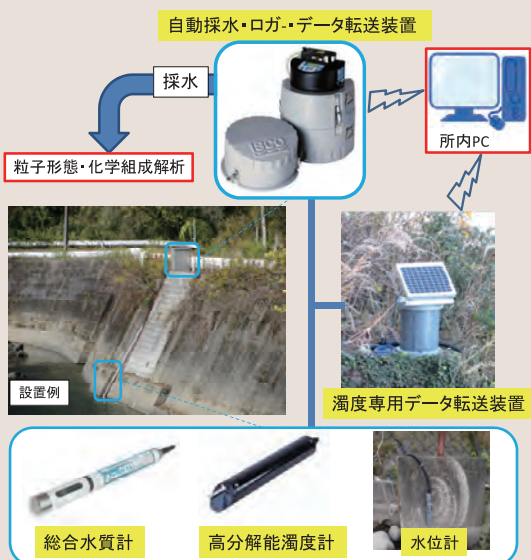
図2 河川内土砂動態観測装置の概要
