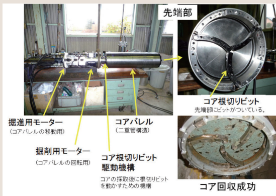
図3 開発した大型ボーリングコア採取装置
