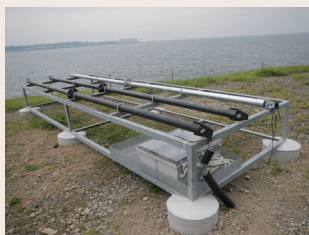
(b) 鋼管水平部材の暴露試験 (2012年8月開始)
