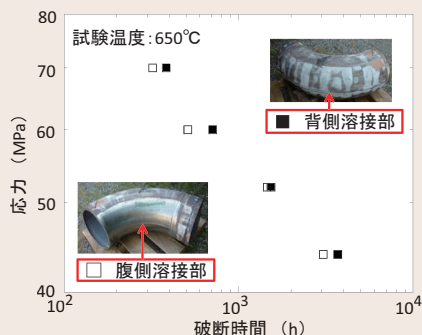
図1 9Cr鋼廃却材のエルボ溶接部のクリープ試験結果の一例
