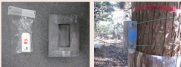
図3 積算線量計と鉛遮蔽体(30mm)を用いたスギ立木の測定
