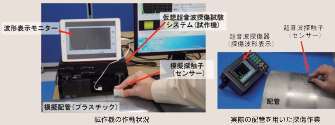
図2 仮想的超音波探傷試験システムの試作機
