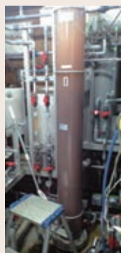
図2 生物学的セレン還元槽(左)と発電所実証試験での処理例(右)
