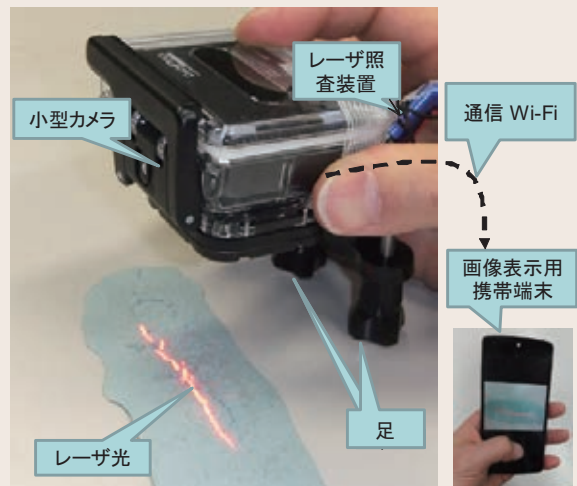
図2 試作した壊食部深さ計測装置
