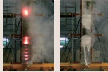
【発火後の燃焼と泡消火設備の作動状況】
