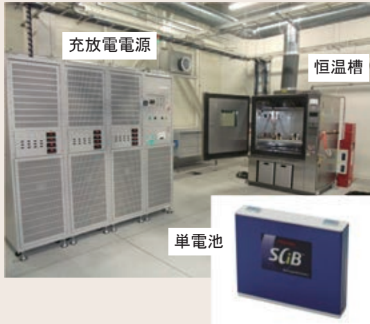
図1 本研究で用いたリチウムイオン電池と充放電試験装置
