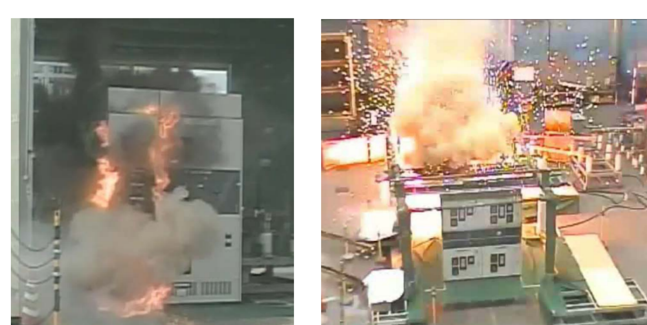
図2-1 電気盤アーク火災試験
