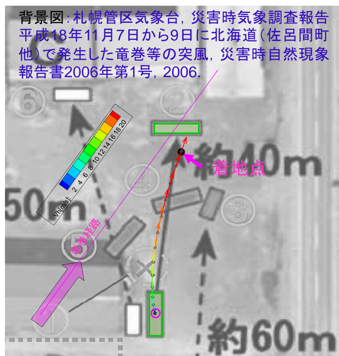
図3-2 竜巻によるトラック飛散現象の再現
