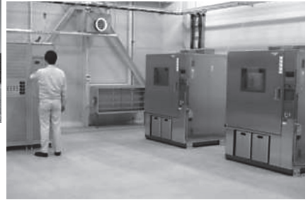
図-6 電中研でのEV・PHEV用リチウム二次電池の加速劣化試験設備(赤城試験センター) 左:高性能電池実験棟、右:加速劣化試験設備
