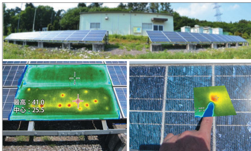
図1 異常のある太陽光パネルを赤外線サーモカメラで撮影した画像
