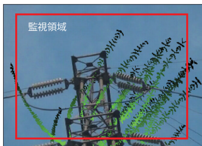
図3 鉄塔に飛来する鳥の検知
