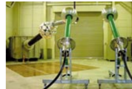
地中ケーブル絶縁前駆信号遮断試験設備
