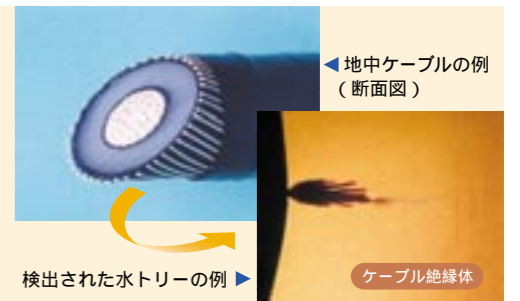
経年地中ケーブルの絶縁性能評価設備。微小な放電前駆信号を検出して絶縁破壊させることなく課電電圧を遮断でき、絶縁性能に影響を与える小さな水トリー（放電痕跡）等の詳細様相を観察可能。
