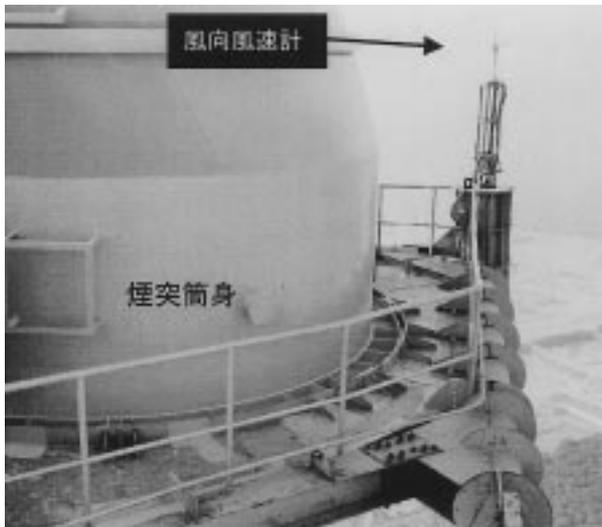
図4-3 集合煙突の支持部材に取り付けられた風向風速計
