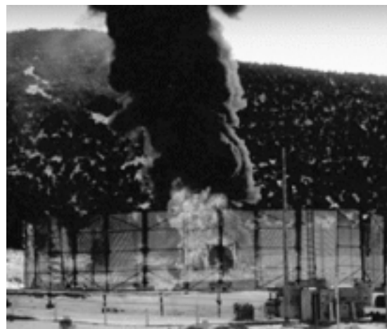
図10-3-1 サンディア国立研究所における輸送物試験体の落下試験及び火災試験
