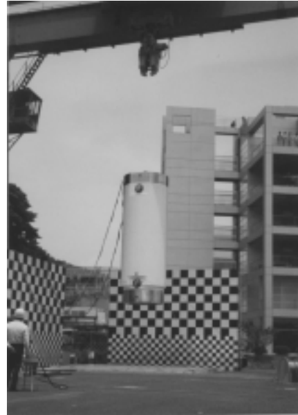
図7-2-1 実証試験用輸送物の9m落下試験
