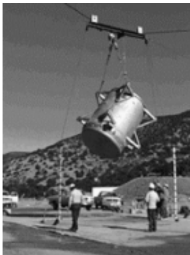
図10-3-1 サンディア国立研究所における輸送物試験体の落下試験及び火災試験
