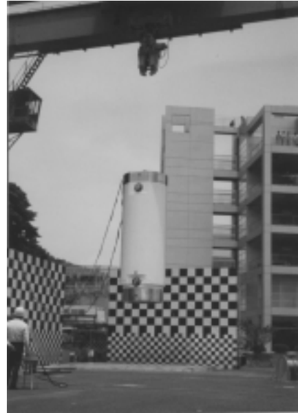
図7-2-1 実証試験用輸送物の9m落下試験
