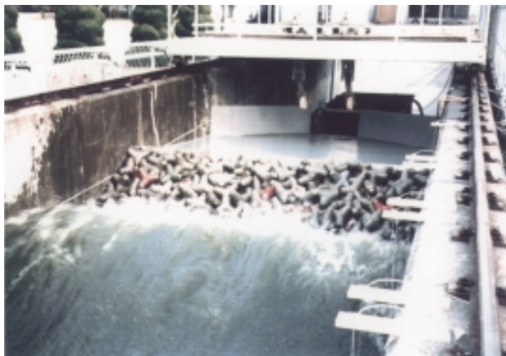
図3-2-4 防波護岸の大型模型水理実験
