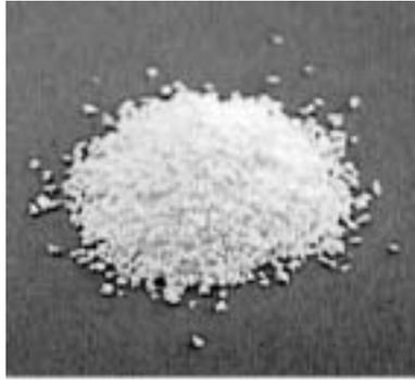
図4-3-9 試作したナトリウム系吸収剤
