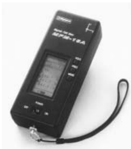
図3-1-2 開発した多機能型磁界計の外観
