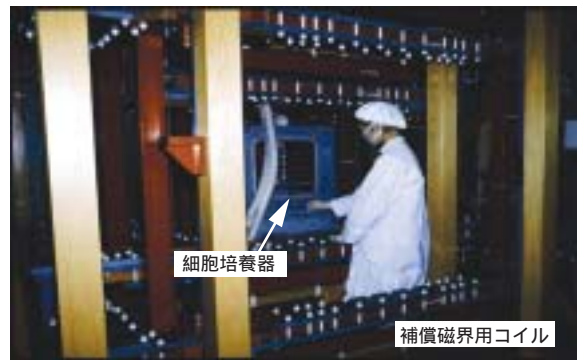
図2-3-4 細胞実験用磁界発生装置
