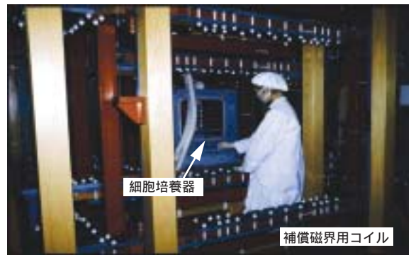
図2-3-4 細胞実験用磁界発生装置
