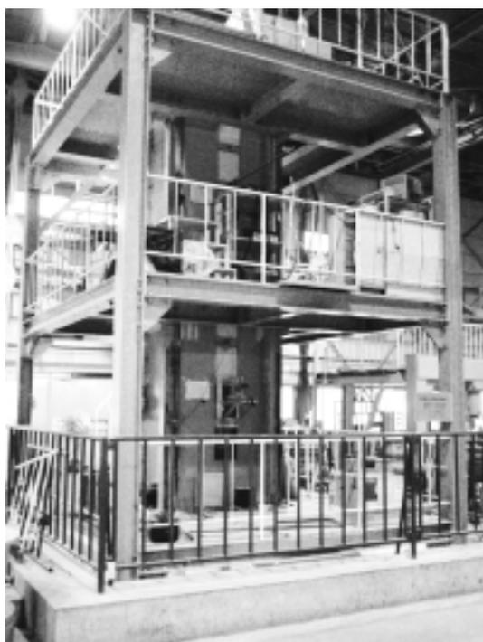
図5-3-7 縦型風洞実験設備
