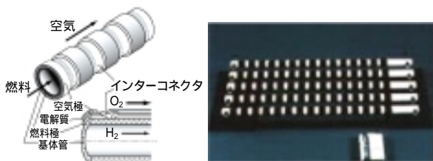
2 横編円筒型SOFC（三菱重工／電源開発） 多孔質の円筒管上に単電池が複数個形成 されている
