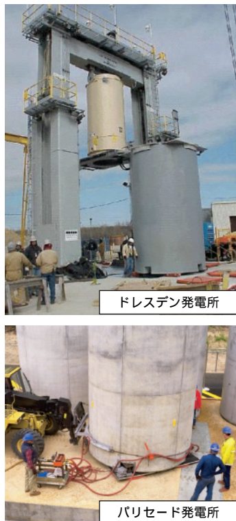
図1-2-4 キャニスタの詰替装置やコンクリートキャスク移送装置の例
