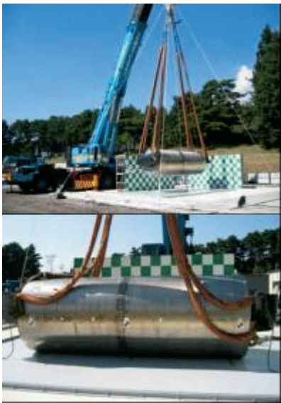
図4-5-4 水平落下試験の実施状況と計測データ(加速度記録波形)の一例
