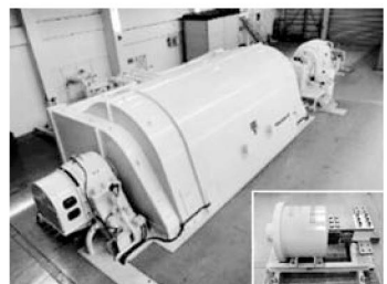
電力中央研究所の短絡発電機と、アジア地区用のレファレンスシャント(右下、写真提供JSTEC)
