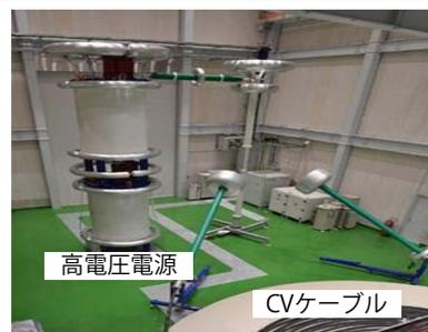
経年CVケーブルの残存絶縁性能試験
