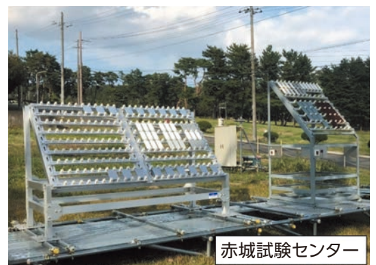
大気ばく露試験設備 (横須賀地区) 実際の環境での腐食試験設備。赤城試験センターでも大気ばく露試験を行っています。
