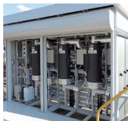
乾式ガス精製システムベンチプラント
