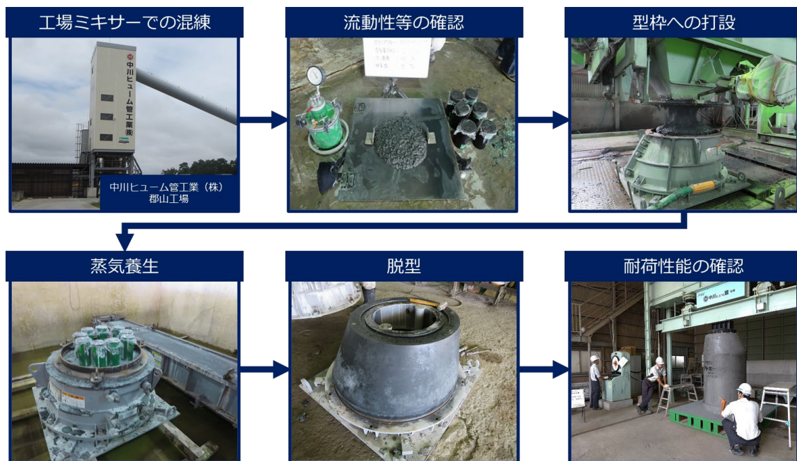
図 2 工場における EeTAFCON 製プレキャスト製品の製造風景
