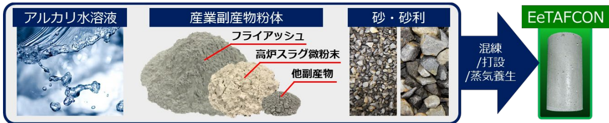
図 1 次世代コンクリート「EeTAFCON」の製造方法
